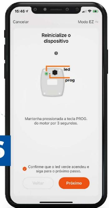
Com o motor ligado na energia elétrica, mantenha pressionada por 3 segundos a tecla PROG, localizada na base do motor. O led irá acender. Informe que o led acendeu e siga para o próximo passo clicando em “Próximo”
